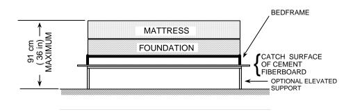
FIGURE 1. TEST ASSEMBLY, SHOWN IN FURNITURE CALORIMETER. (CONFIGURATION A.)
